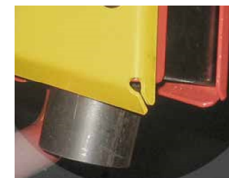
Buse d'aspiration de la sciure (option)
