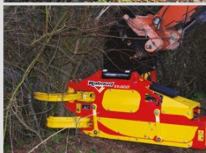
Coupe de taillis à la brassée au ras du sol.
