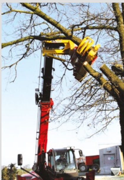
Élagage des branches sur le côté grâce à l'inclinaison hydraulique -18°/+85°.
