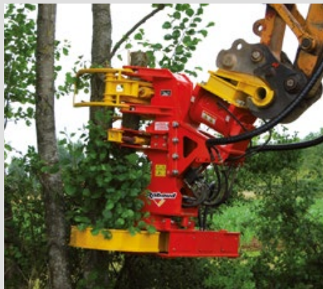
Coupe de taillis à la brassée grâce à la pince accumulatrice (option).
