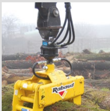
Cardan de suspension sur Mini-pelle ou Grue
