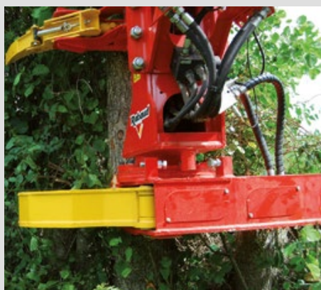
Couteau monté sur support mobile amplitude de 38,5, uniquement sur XYLOCUT 410 PE.
