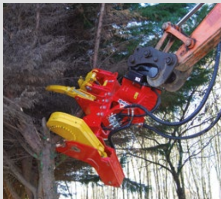
Élagage des branches sur le côté grâce à l'inclinaison hydraulique +/- 90°.
