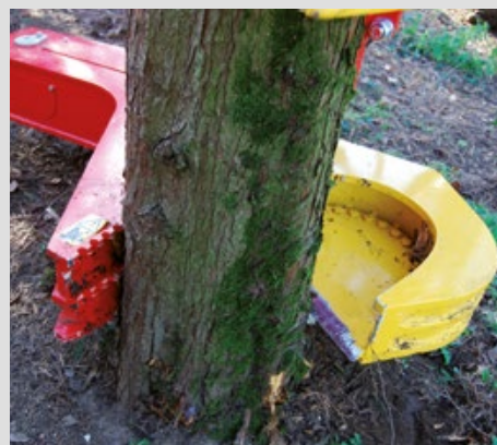
Couteau de coupe boulonné avec couteau de finition.
