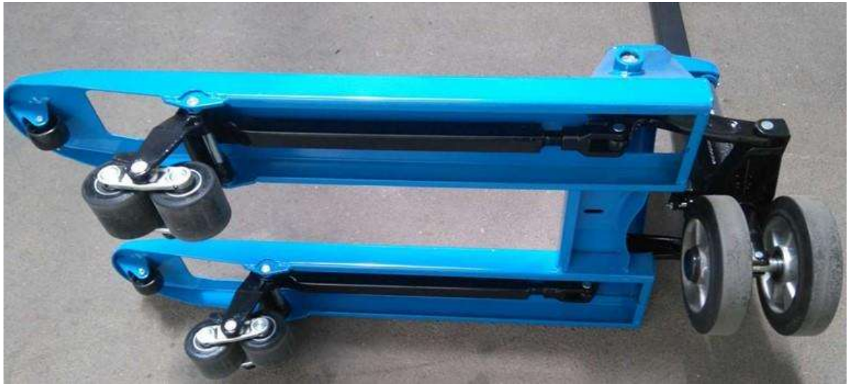
Vue de dessous : Galets en PU en tandem, galets d'entrée, roue AR caoutchouc
