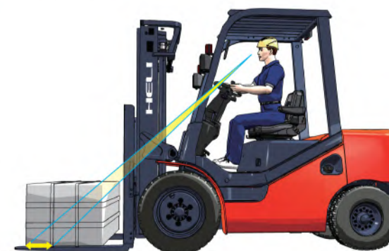
■ visibilité en bout de fourche et marchandises augmentée de 20mm.
