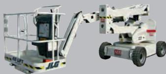
Nacelle automotrice à bras électrique
