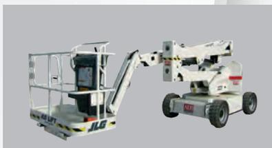
Nacelle automotrice à bras électrique
